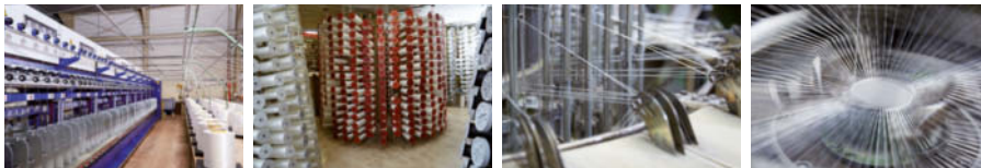
Bei der maschinellen Schlauchproduktion laufen alle Fäden zusammen, wenn es um die stabile Ummantelung mit Polyestergewebe geht. Modern Zwirn- und Webtechnik ist hier gefragt.
